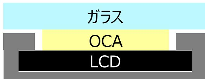
柔軟で厚膜のOCAを適用することで応力緩和の効果が期待でき、LCDの表示ムラの抑制に繋がる
