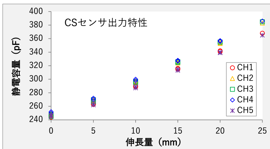
図 1. CS センサ出力特性 (変位量と静電容量の関係)
